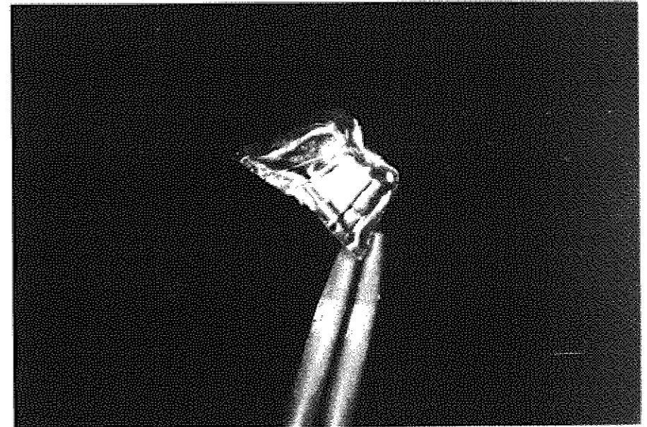
*Fig. 7 - Cappetta dopo la fusione dell'oro.*
